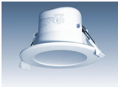
Lichstarkes, komplett gekapseltes LED-Downlight (Einbaustrahler) 7 W in robustem Kunststoffgehäuse, mit Frontscheibe und integriertem Transformator. Farbtemperatur (Lichtfarbe) mittels Schiebeschalter umschaltbar von Kaltweiß (ca. 6000 K), über Neutralweiß (ca. 4000 K), bis zu Warmweiß (ca. 3000 K)
