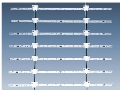
RGB-LED-Gitter-Leuchte zur farbigen Hinterleuchtung großer und größter Flächen. Abstand zur hinterleuchteten Fläche ab ca. 90 mm. Leuchte bestehend aus 40 LED-Leisten, die im Abstand von ca. 50 mm parallel zu einander angeordnet und verbunden sind. Die einzelnen Leisten sind bestückt mit 12 RGB-LEDs. Je Leiste 2,8 W, max. ca. 78 lm., Maße 496 x 10 x 7 mm.
