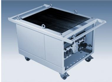
Mobiler Trenntransformator für den Einsatz auf Baustellen, im Behälterbau, im Werkstattbereich, u.a. Robustes Metallgehäuse IP54, auf Rollen, mit Transportösen. Eingang 3 x 400 V mit 16 A-CEE-Stecker. 3 Ausgänge 230 V mit 16 A-Schuko Steckdose (Dauer-Nennleistung je 14,5 A). Sekundär je Steckdose ein
