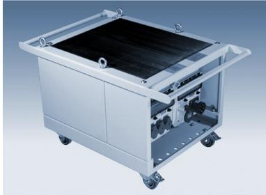
Mobiler Trenntransformator für den Einsatz auf Baustellen, im Behälterbau, im Werkstattbereich, u.a. Robustes Metallgehäuse IP54, auf Rollen, mit Transportösen. Eingang 3 x 400 V mit 16 A-CEE-Stecker. Ausgang 3 x 400 V mit 16 A-CEE-Steckdose (Dauer-Nennleistung 3 x 14,5 A). Sekundär Sicherungsautomat.
